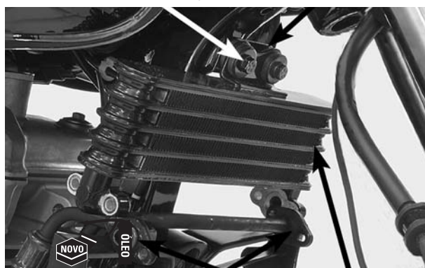
ANÉIS DE VEDAÇÃO RADIADOR DE ÓLEO
